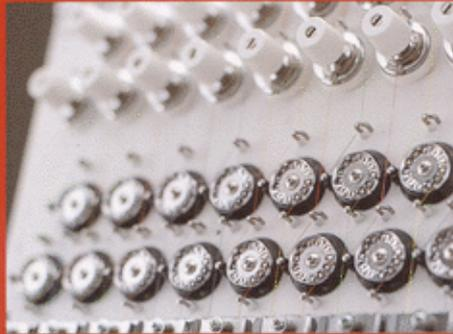
Rotierende Fadenbruchsensoren erkennen präzise jeden Ober- und Unterfadenbruch, halten automatisch die Stickmaschine an und geben dem Anwender ein akustisches Signal.
