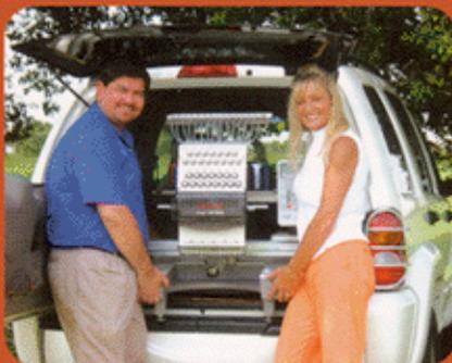
Die ESP9000 ist leicht genug um von 2 Personen getragen zu werden. Der Stickkopf wurde in leichtbauweise auf Aluminumbasis gefertigt. Fortschrittlichste technische Einrichtungen machen diese Industriestickmaschine portabel und vielseitig.
